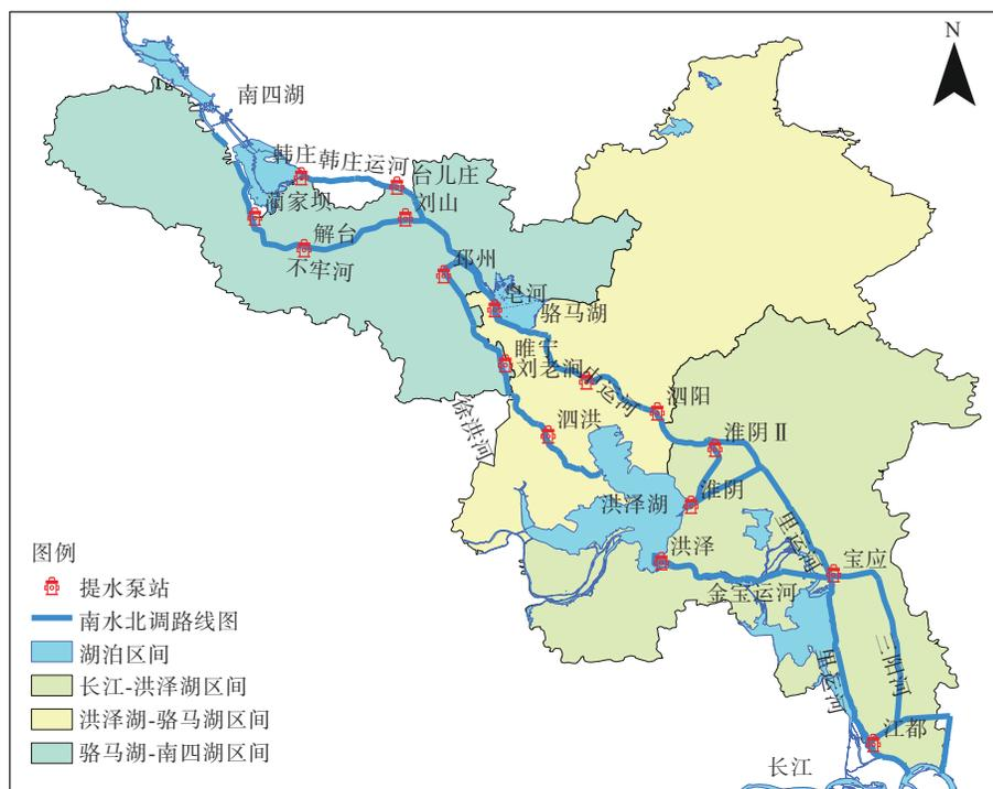
图 1 南水北调东线工程江苏段水资源系统概化图
