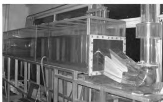
图 4 进水流道模型试验装置
